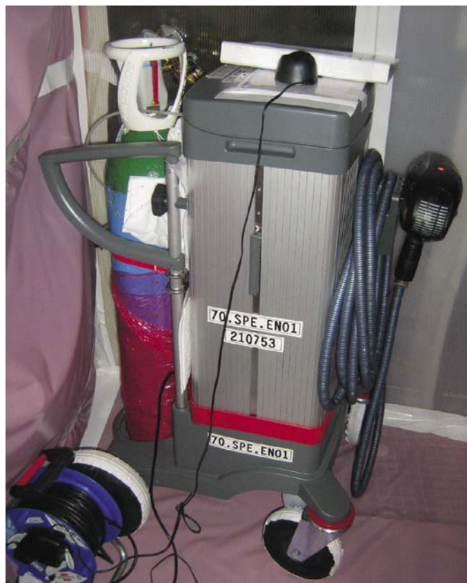
→ Bouteille d'argon pour mise sous atmosphère neutre de la zone et pour effectuer des mesures non perturbées
